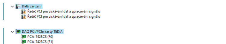
Obr. 9. Zobrazení dvoufunkční PCI karty ve Správci zařízení.
